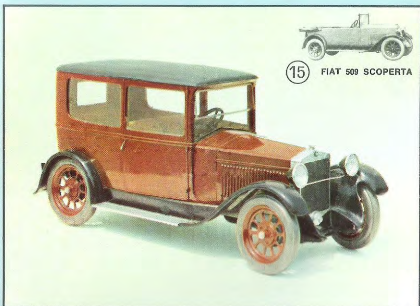
⑭ FIAT 509 La prima automobile utilitaria fabbricata in Italia cmc 990 HP 12 4 cilindri
